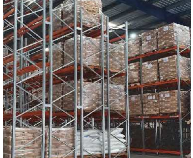
Estanterías de doble profundidad para palets
