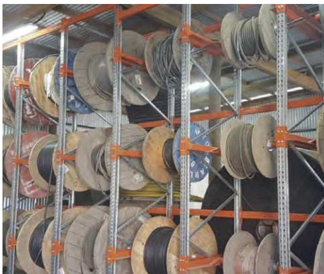
Almacenaje de bobinas de distintos pesos y dimensiones
