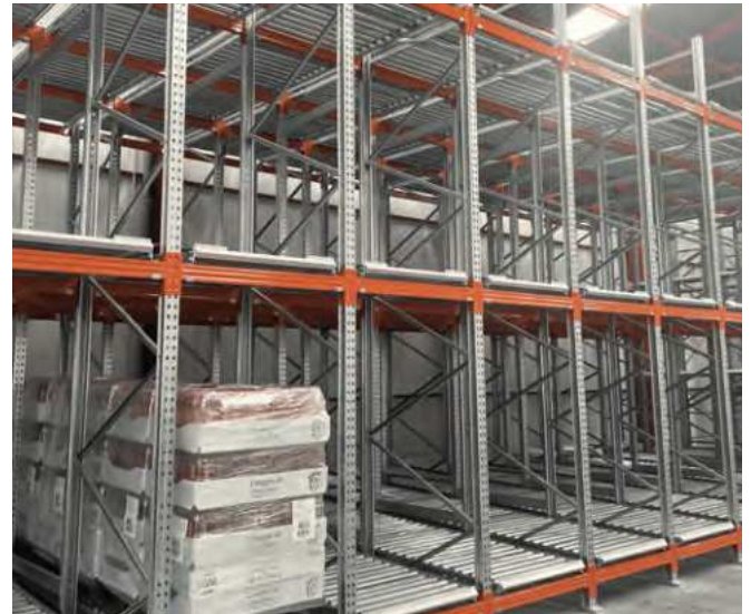
Almacenamiento de palets en estanterías dinámicas
