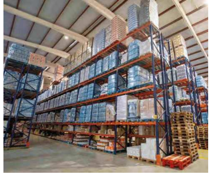
Estanterías convencionales con niveles de picking
