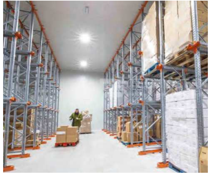
Estanterías compactas en cámara frigorífica
